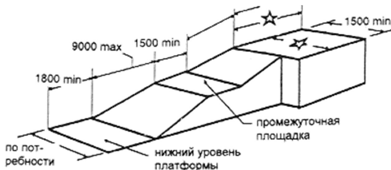
Рисунок 2.3.2 - Пандусы для входа в здания
